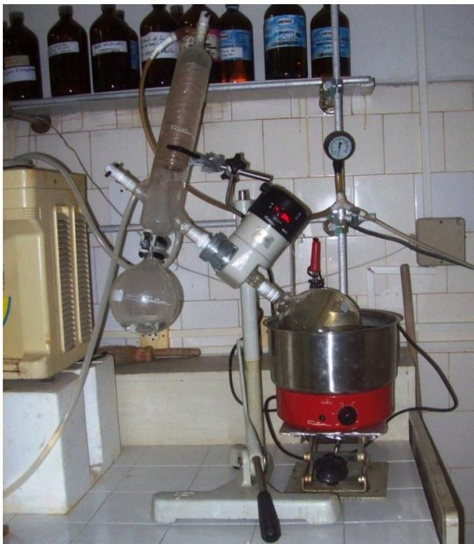
Figura 4: Evaporação a vácuo – Extrato de *Mentha piperita*.
