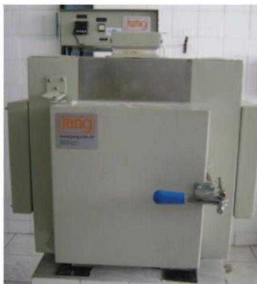
Figura 3.8 – Forno tipo mufla, Jung 0614, temperatura máxima de 1400°C.
