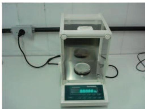
Figura 3.1 – Balança analítica
