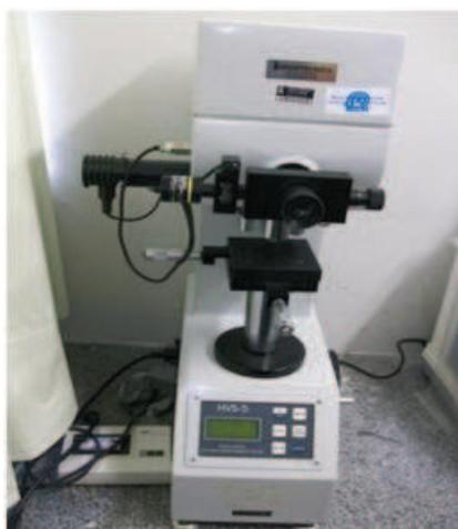
Figura 3.11 - Microdurômetro acoplado a um microscópio metalográfico Zeiss, modelo Jenavert com penetrador modelo HVS-5 nº 0021
