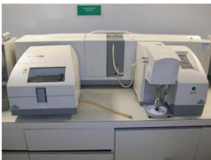
Figura 3.6 - Analisador de tamanho de partícula a laser, Malvern Mastersizer 2000 MU
