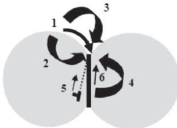
Figura 2.12 – Representação esquemática da transferência de massas, num modelo esférico de partículas, durante a sinterização [78].
