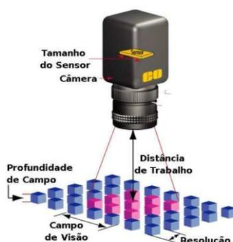
Figura 53. Parâmetros fundamentais para definição de um sistema óptico (STEMMER et al, 2005).
