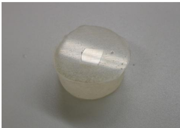
Fig. 8 – Corpo de prova ao final das etapas de planificação e polimento
