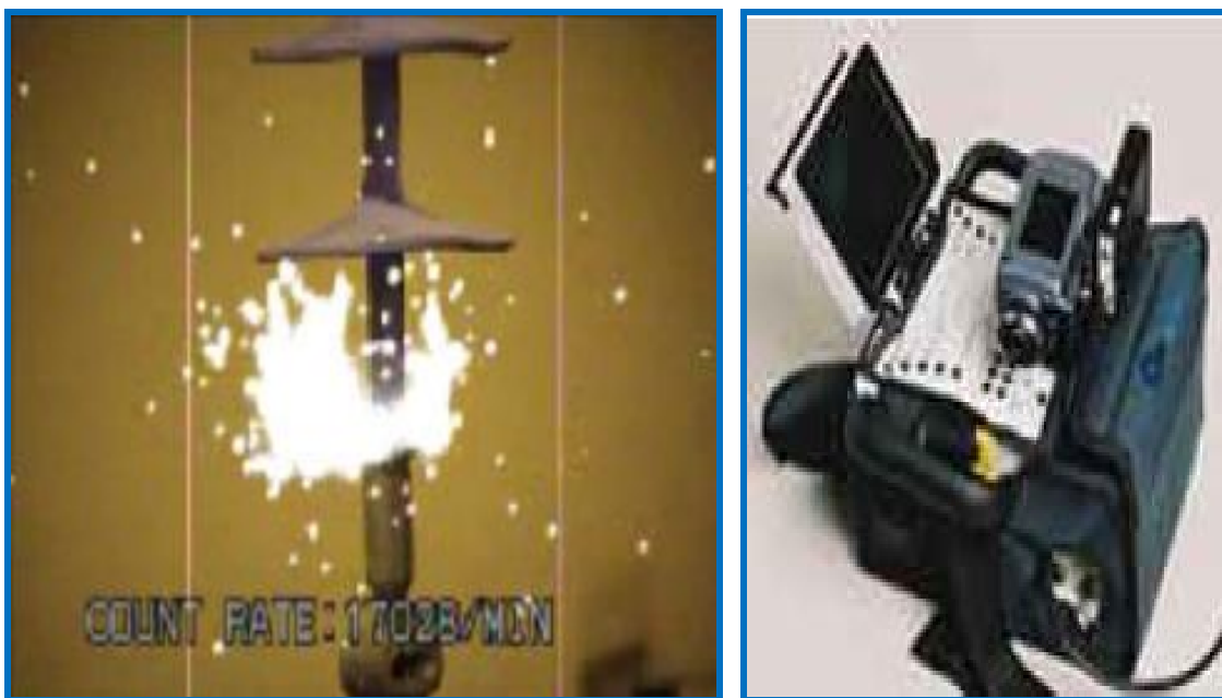
Figura 17 - (a)imagem com visualização de pontos de UV e (b)equipamento detector de UV (Tarso Ferreira , 2007).
