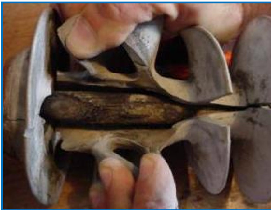
Figura 45 - Detalhe do Isolador tipo bastão de 72,5kV onde verifica-se a falta de aderência entre o revestimento polimérico e o núcleo de fibra de vidro.
