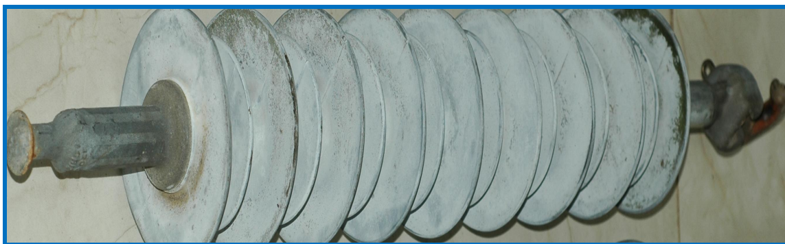
Figura 495 - Isolador aparentemente íntegro que foi submetido à análise para constatação de possíveis defeitos.
