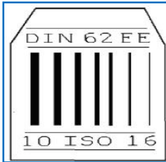
Figura 9 - Indicador de Qualidade de Imagens (IQI) ( http://octarine.adfa.edu.au:8080/~kks/NDI/chap6-rad.rtf , 2004)
