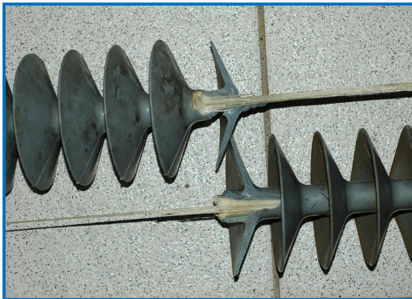
Figura 58 - Isolador que falhou por fratura frágil.
