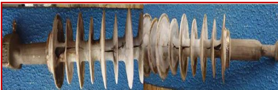
Figura 404 - Detalhe do Isolador tipo bastão de 69kV que veio a falhar por Disrupção Dielétrica Interna. É fácil verificar a perda de material polimérico tanto no lado fase quanto no lado terra.
