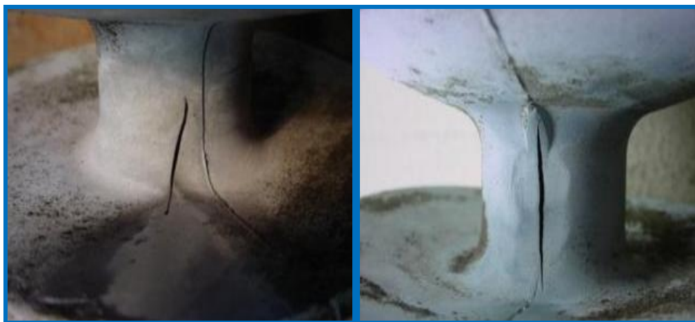
Figura 473 - Detalhe do Isolador onde verifica-se falhas de fabricação através da presença de cavidades.
