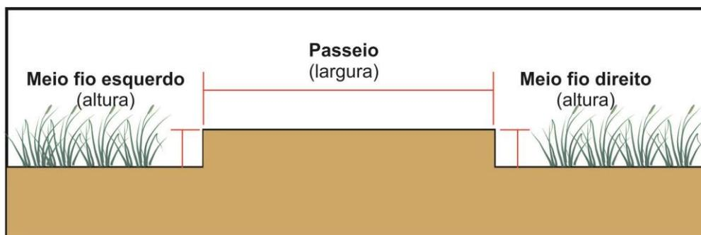
Figura 32 - As áreas de medição dos passeios
