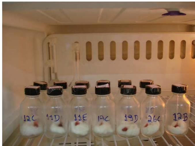
Figura 16: Espécimes mantidos sob refrigeração em ambiente fechado e úmido até a leitura de microdureza.
