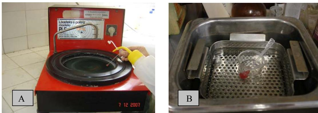
Figura 10: A) Polimento da amostra na Politriz modelo PLF da marca FORTEL. B) Amostra submersa em 20 mL de solução PBS - Banho de ultra-som (Ultra-som Thornton).
