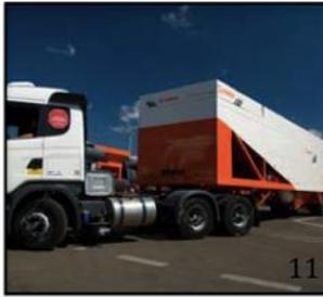
**11. Usina de asfalto Kompakt:** O asfalto para pavimentar estradas é produzido em usinas instaladas normalmente no ponto de início das obras. À medida em que a rodovia é pavimentada, o caminhão carregado com o asfalto quente precisa percorrer distâncias cada vez maiores. Este novo veículo concentra todos os elementos componentes de uma usina de asfalto, consistindo numa verdadeira “usina sobre rodas”, que torna a pavimentação de estradas mais rápida e barata (Bertussi Designindustrial, 2008)
