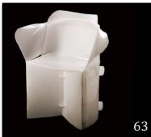
**63. Cadeira Envelope:** com leveza e portabilidade, esta cadeira explora um material novo para o segmento: uma folha de plástico polipropileno de 2 mm de espessura, cortada e dobrada, o designer consegue atender aos requisitos de forma e função, cabendo num envelope de papelão ondulado de 125 cm de comprimento, 75 cm de altura e 1 cm de espessura que facilita seu armazenamento e transporte (Marcelo Molleta, 2000)
