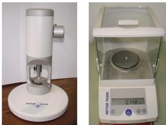
Figura 3-4 - Encapsulamento e medição da massa das amostras de gipsita.
