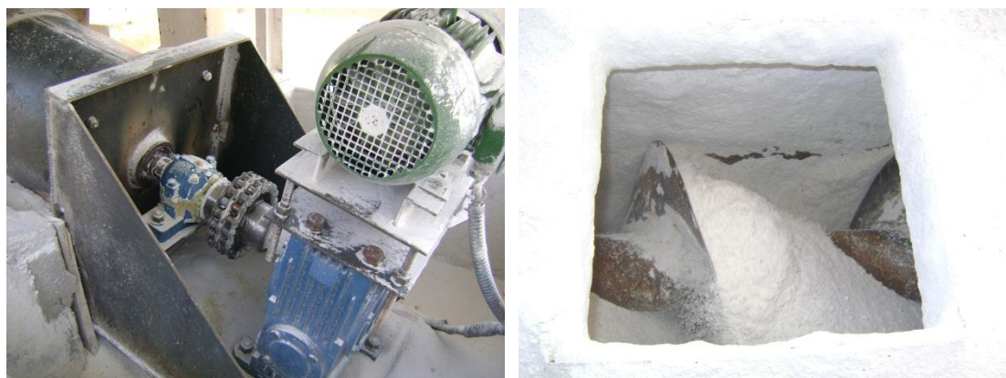
Figura 1-3 - Processo de moagem da gipsita – Calcinadora AM Gesso.
