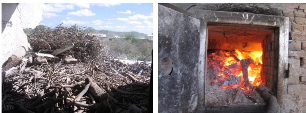
Figura 2-3 - Lenha utilizada como fonte energética na calcinação da gipsita.
