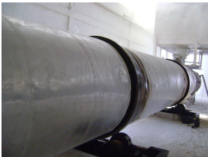
Figura 1-16 - Forno do tipo tubular paralelo – Calcinadora Calmina.
