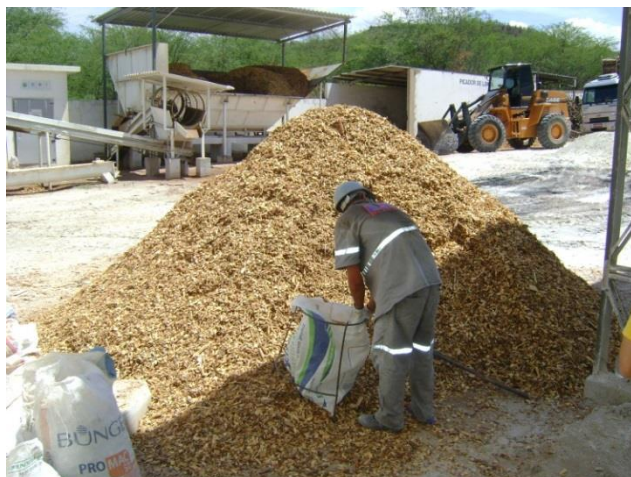
Figura 2-2 - Cavaco de lenha utilizada como fonte energética na calcinação da gipsita. Calcinadora AM Gesso.
