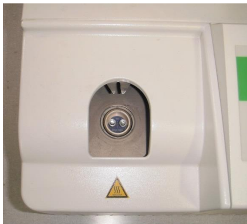
Figura 3-3 - Calorímetro diferencial (Universidade Federal de Pernambuco).
