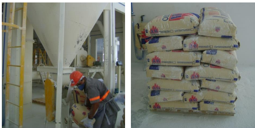
Figura 1-4 - Processo de embalagem da gipsita – Calcinadora AM Gesso.
