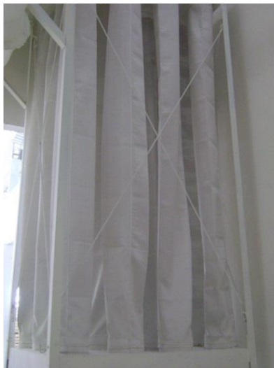
Figura 1-14 - Filtro de mangas para retenção de particulados – Calcinadora AM Gesso.
