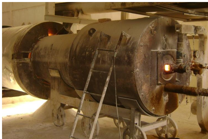
Figura 1-6 - Câmara de combustão de um forno rotativo – Calcinadora Calmina.
