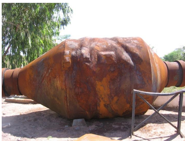
Figura 1-19 - Forno rotativo danificado pelo uso do coque de petróleo como fonte energética para calcinação da gipsita.
