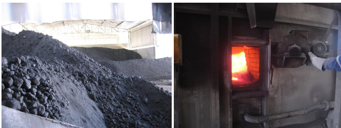
Figura 1-18 - Coque utilizado como fonte energética na calcinação da gipsita.
