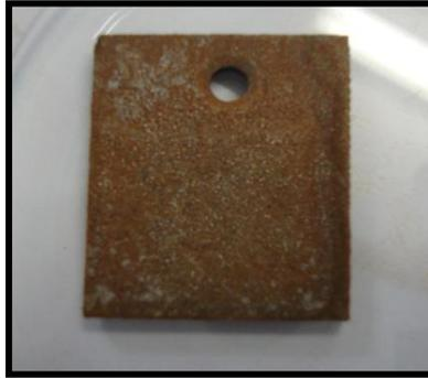
**Figura 5.8 – Cupom de aço carbono exibindo corrosão uniforme após a remoção do biofilme com espátula estéril.**
