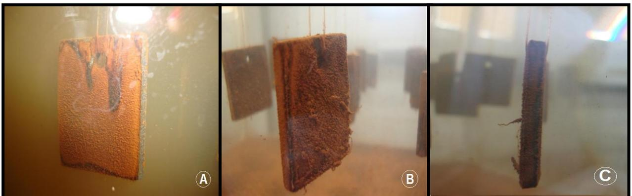
**Figura 5.6 – Cupons de aço carbono SAE 1010 expostos à água doce após (A) 15 dias, (B) e (C) 30 dias.**
