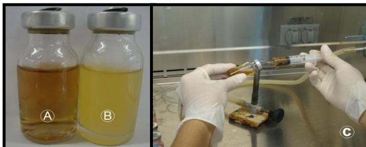
**Figura 4.11 – Meio fluido tioglicolato. (A) Meio sem inóculo; (B) Meio turvo indicando crescimento das bactérias heterotróficas anaeróbias totais; (C) Inoculação no meio com seringas descartáveis.**
