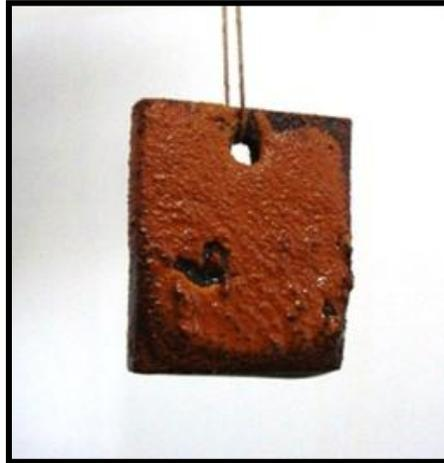
**Figura 5.4 – Biofilme formado na superfície do aço carbono SAE 1010 após 30 dias de exposição ao fluido.**
