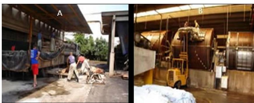
Figura 4- Recepção de peles salgadas (A) e fulões (processamento de peles) (B)
