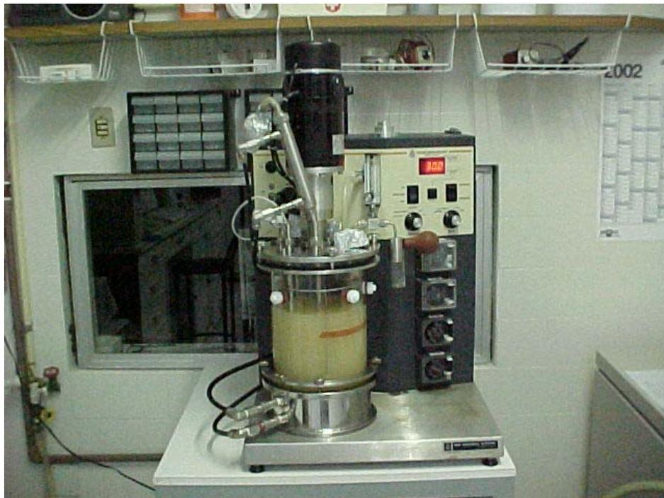
Figura 01. Biorreator modelo Bioflow III (New Brunswick) tipo tanque agitado, usado na fermentação realizada para estudo da cinética da produção de oligossacarídeos.
