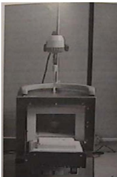
**Figura 3.2** Sistema forno agitador utilizado para a redução de estrias nas matrizes BF e PGO [75].
