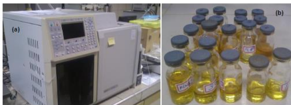
Figura 5: Análise realizada por cromatografia gasosa modelo Varian (a). Amostras coletadas (b).
