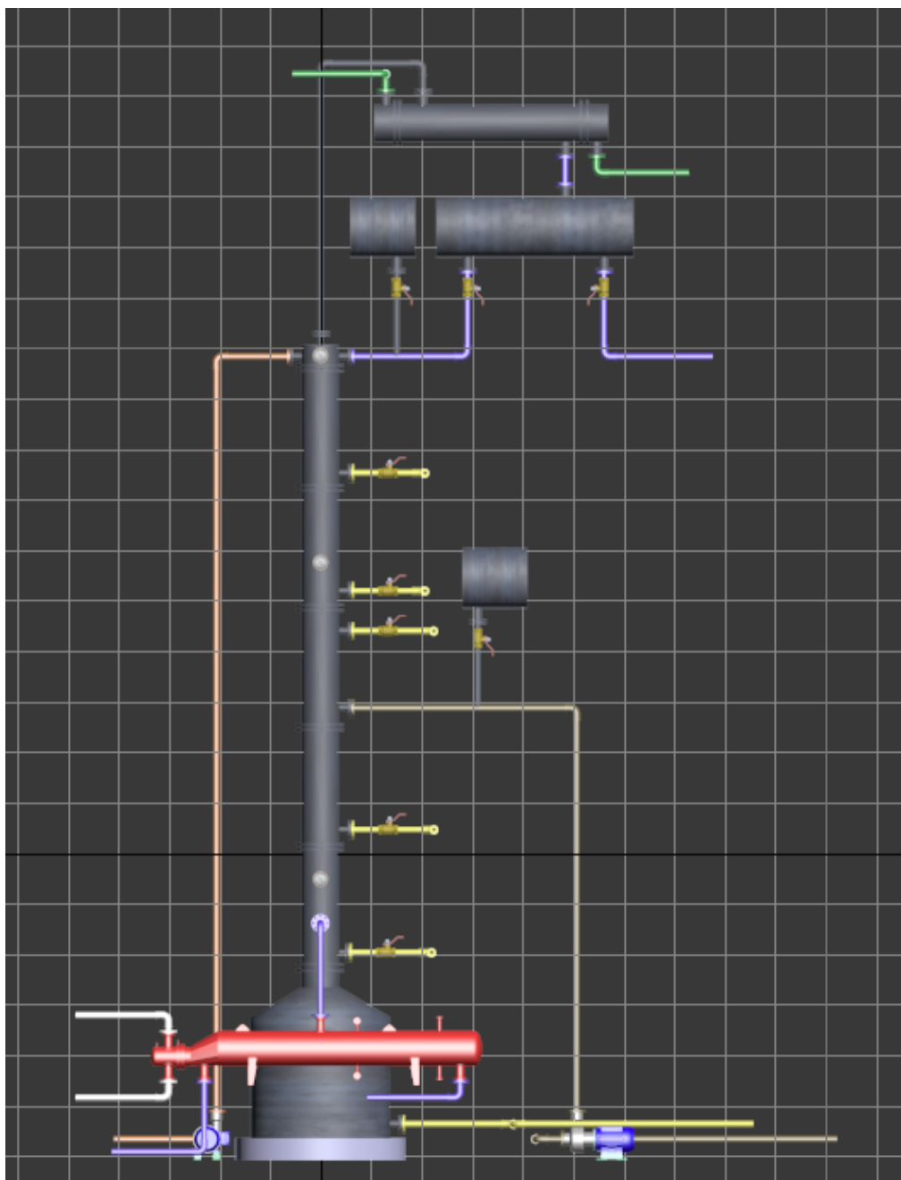
Figura 46: Projeto da coluna de destilação reativa, extrativa e absorviva para a produção de biodiesel.
