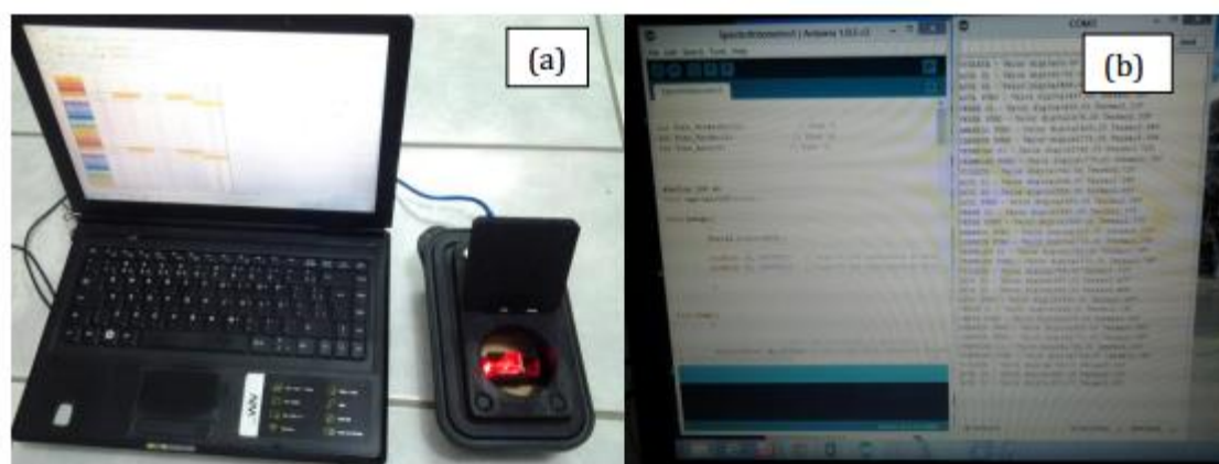
Figura 3 – Fotômetro ligado a um notebook (a). Varredura dos sinais (b).
