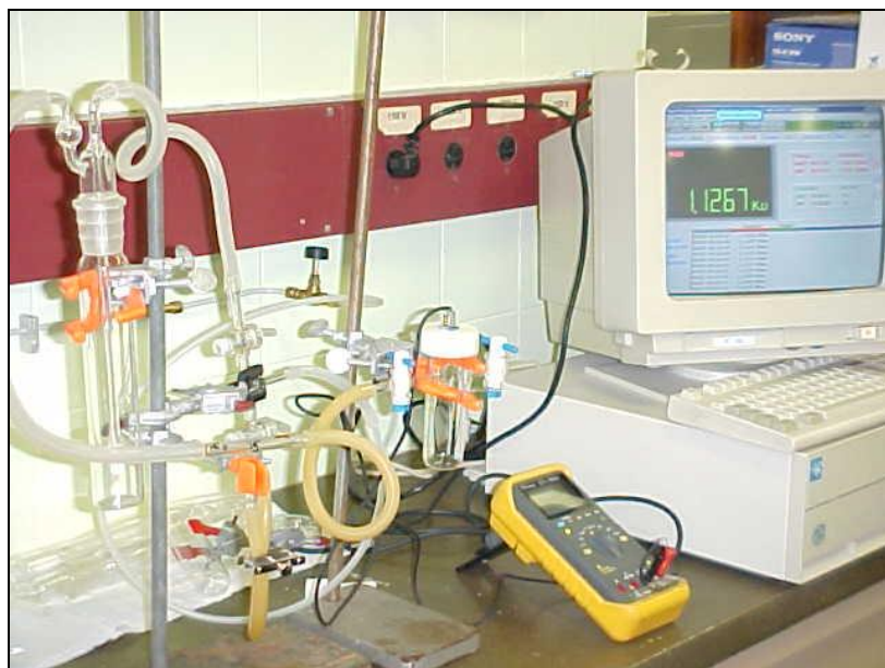
Figura 43 – Foto do dispositivo de testes da sensibilidade dos sensores.
