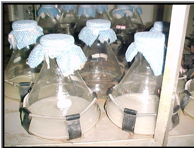
**Figura 7 – Experimentos de biodegradação em frascos Fernbach**
