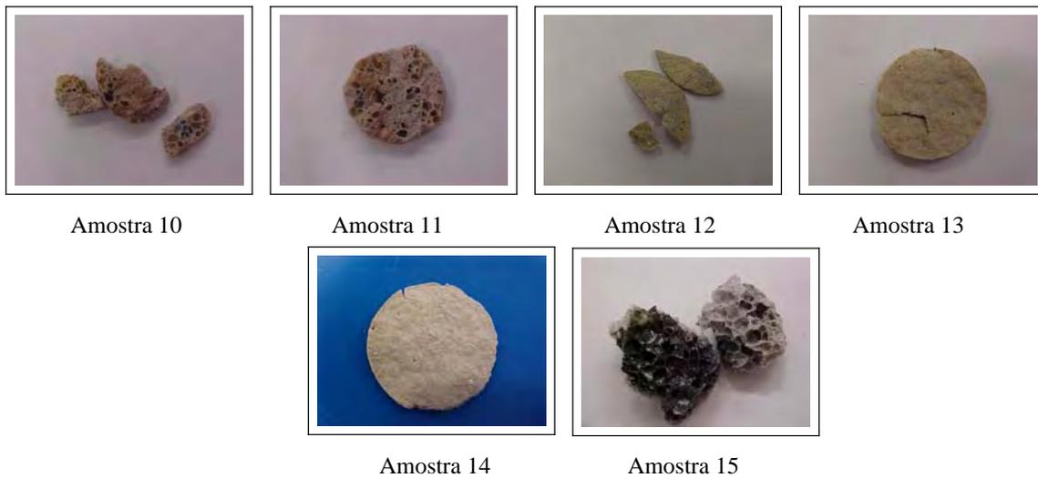
Figura 4.5: Fotografias das amostras SIPPNa, referentes à Tabela 4.1, em que os materiais foram obtidos a partir da adição de sódio ao SIPP - nas amostras 01, 02, 03, 04, 05, 06, 07, 08 o sódio está na forma de NaCl; nas amostras 10, 11, 12, 13, 14, o sódio é proveniente do NaNO<sub>3</sub>; e na amostra 15 se utilizou o Na<sub>2</sub>O.
