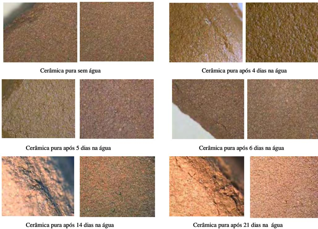
Figura 5.4: Cerâmica sem frita após submetida a água e sem submeter a água.
