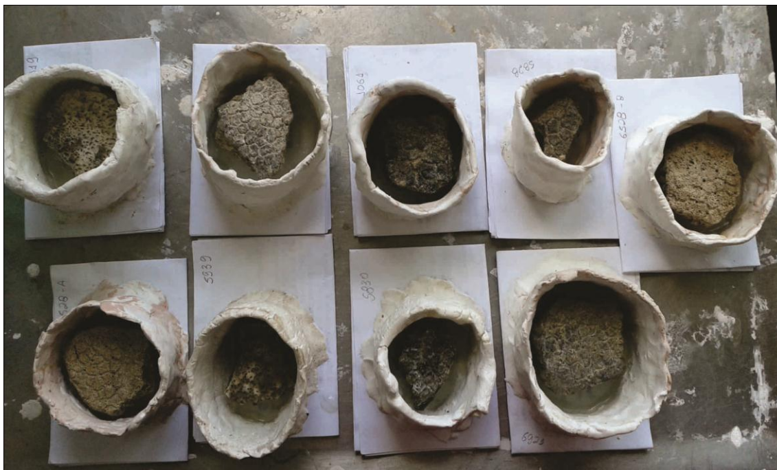
Figura 6 - Espécimes sendo impregnados com resina epóxi para confecção das lâminas histológicas.
