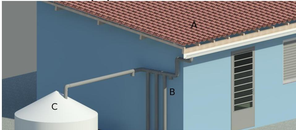
Legenda: A – telhado; B – dispositivo de desvio em PVC; C – cisterna.
