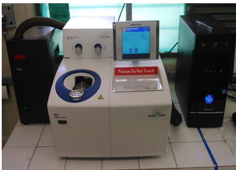
Figura 17 - Equipamento DSC 1 STAR ® SYSTEM
