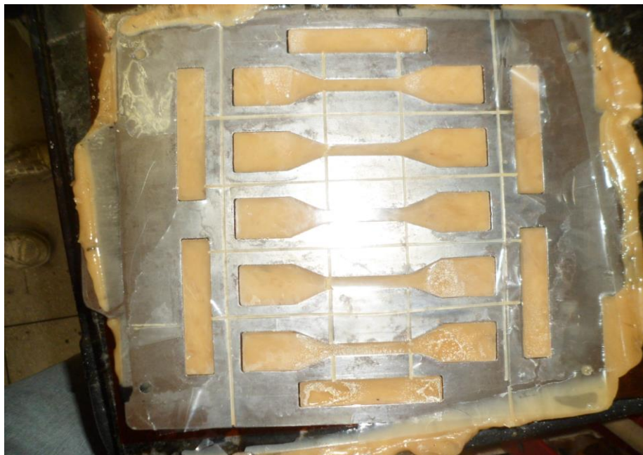
Figura 15 – Molde para confecção dos corpos de prova
