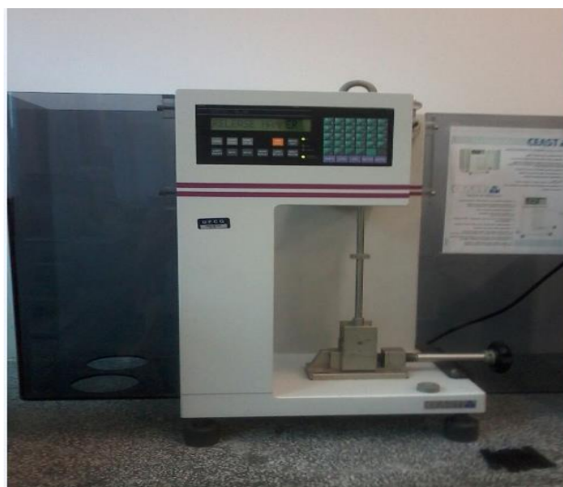
Figura 19 – Máquina de impacto CEAST, modelo RESIL 5,5.
