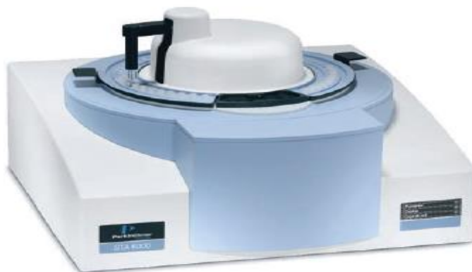
Figura 16 – Termobalança Perkin Elmer, modelo STA 6000.
