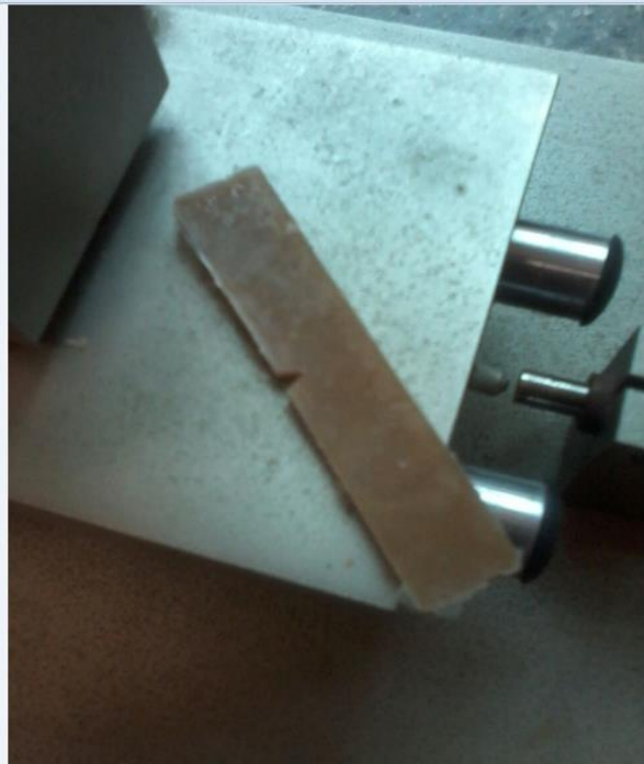
Figura 20 – Corpo de prova com entalhe.
