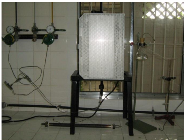
Figura 10 - Forno Lindenberg Blue de calcinação e redução dos catalisadores.
