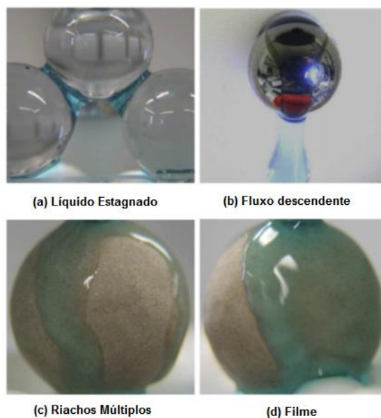
Figura 7 - Modos de escoamento em reatores de leito gotejante (SCHWIDDER et al. , 2012)
