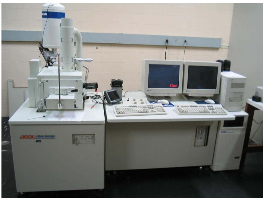
Figura 3.1 Foto do microscópio eletrônico de varredura do departamento de física da UFPE. O microscópio utilizado é da marca JEOL e o modelo JSM 5900.
