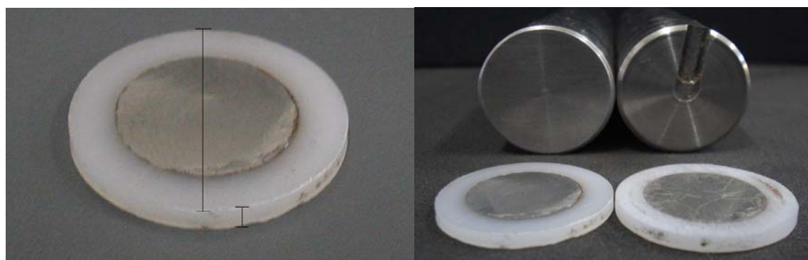
Figura 4.3 Amostra de 23mm de diâmetro e 2mm de espessura.
