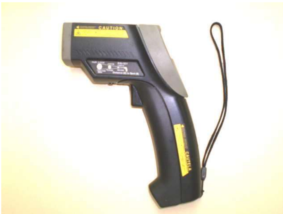
Termômetro sem contato (laser), modelo ST Pro – Raytek. Equipamento utilizado para medição de temperatura das mãos.
