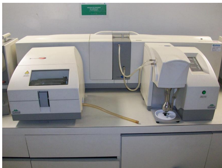
Figura 3.7: Analisador de tamanho de partícula a laser, Malvern Mastersizer 2000 UM
