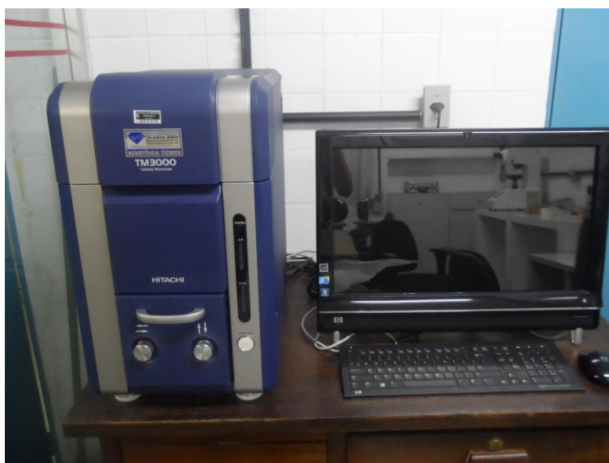
Figura 3.9: Microscópio eletrônico utilizado para obter as imagens das superfícies das pastilhas.
