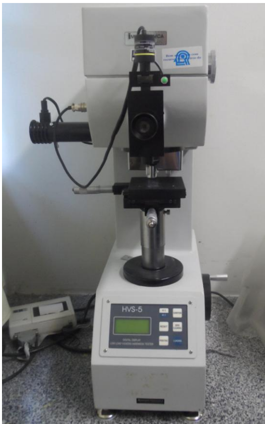
Figura 3.11: Microdurômetro acoplado a um microscópio metalográfico Zeiss, modelo Jenavert com penetrador modelo HVS-5 nº 0021
