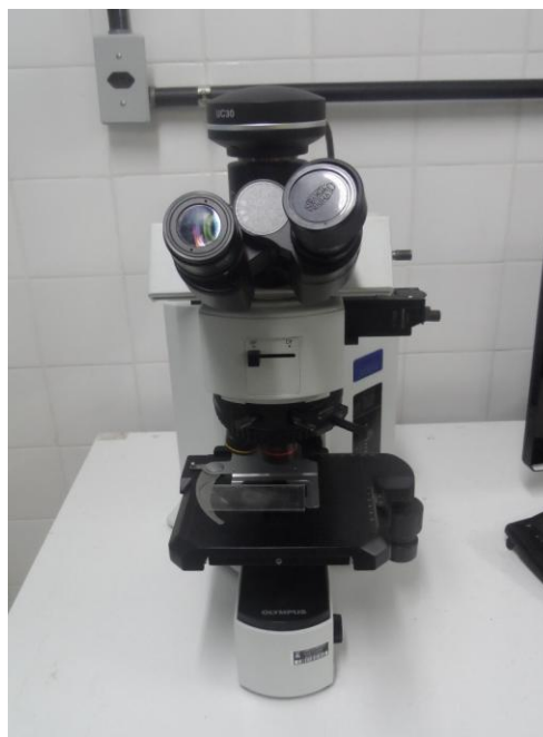
Figura 3.8: Microscópio óptico utilizado para analisar a superfície das amostras sinterizadas.
