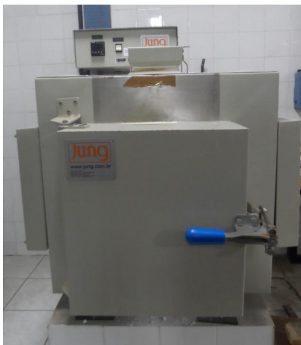
Figura 3.5: Forno tipo mufla, Jung 0614, temperatura máxima de 1400°C.
