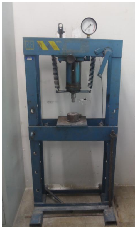
Figura 3.3: Prensa hidráulica utilizada para compactação
