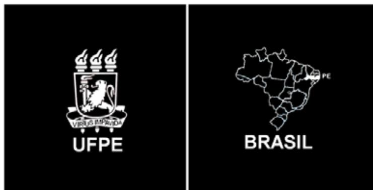
Figura 5.1. Máscaras utilizadas na litografia 2D mostrada em duas etapas.
