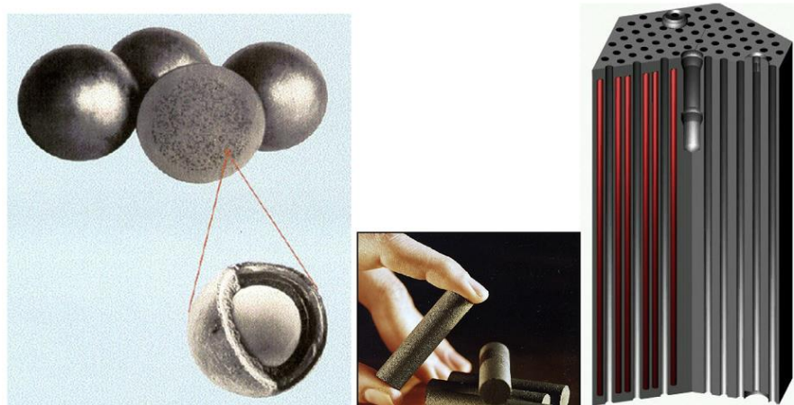
Figura 2 - Forma macroscópica do combustível dos VHTRs, bolas (esquerda), compacto (direita).
