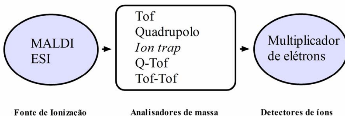
Figura 8 - Componentes básicos dos espectrômetros de massa: a fonte de ionização (responsável pela introdução de cargas e vaporização de amostras), o analisador (determina a relação m/z do analito) e o detector (detecta a presença do analito). Os íons são produzidos na fonte de ionização e subseqüentemente separados em um analisador, seguindo para um detector.
