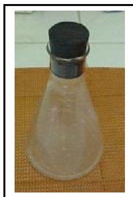
Figura 3.4– Aparato experimental “B” para verificação de perdas abióticas de xileno.
