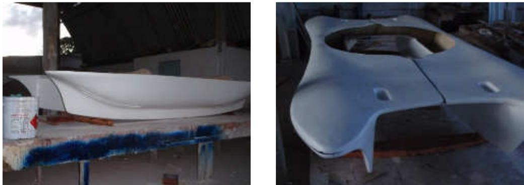
Na montagem do casco ainda foram considerados dispositivos de segurança para evitar o afundamento pleno do protótipo em caso de avaria através do enchimento do volume do casco com garrafas PET além da divisão do casco em 2 vezes 3 compartimentos estanques, divididos por lâminas de fibra de vidro (Figura 92).
