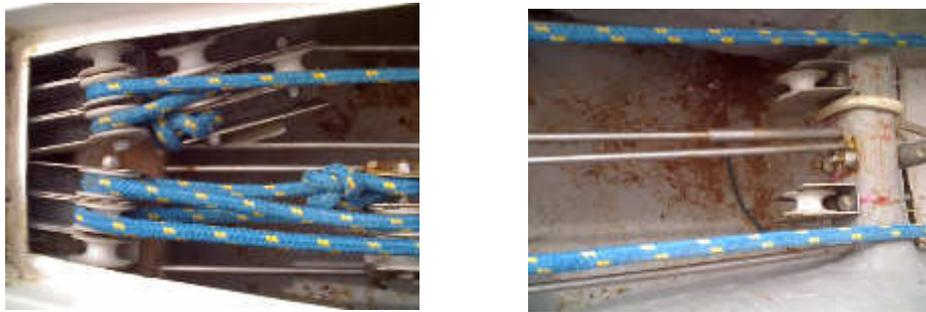
Para manter o ângulo de ataque em posição, a corda auxiliar é fixada com um prendedor de cordas“mostrado na Figura 105.
