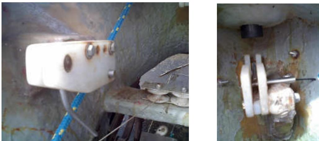
Foram instalados 3 desconectores das linhas do Kite. A foto à esquerda da Figura 106 mostra aparelho que prende e desconecta uma linha dianteira ou as duas linhas dianteiras do
