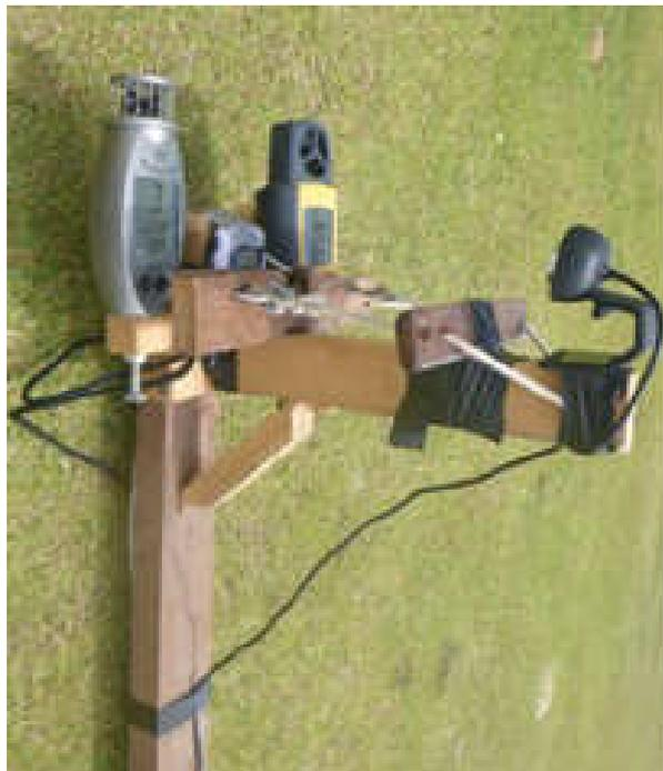
A webcam utilizada para captação das imagens dos anemômetros e do relógio e com um cabo extensor USB de 10 metros foi ligada ao laptop. O relógio, sincronizado com o GPS, foi colocado entre os anemômetros e com isso foi possível verificar continuamente durante todo o percurso do barco a velocidade do vento, a temperatura e a hora da medição.
