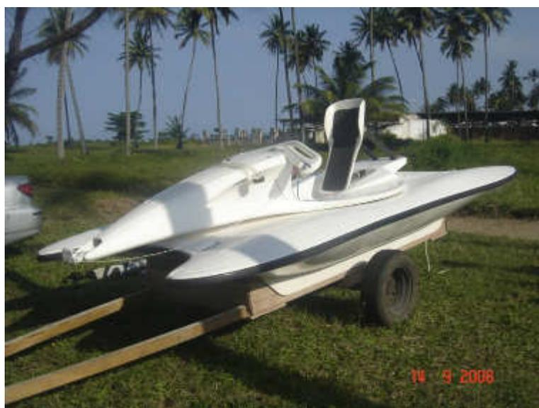
O Mock-Up ou modelo do segundo protótipo, que é um modelo na escala 1:1 (Fig. 17) pode servir como base para o desenvolvimento de um terceiro barco, ultraleve e funcional utilizando as novas tecnologias testadas nos protótipos e modelo anteriores. A tecnologia aplicada na fabricação do modelo do protótipo ocorreu em alto grau artesanal, resultando em grande peso desnecessário e infiltrações devido às tolerâncias processuais inerentes à fabricação artesanal.
