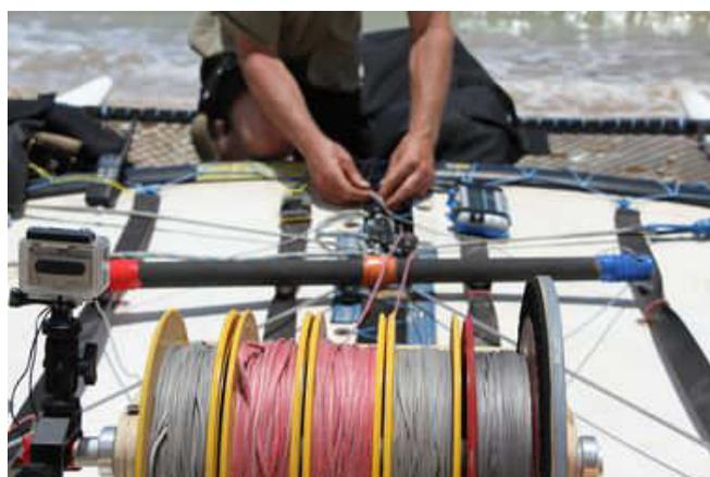
Uma ênfase no desenvolvimento é o aperfeiçoamento de sistemas de hidrofólios auto adaptáveis, que permitem velocidades elevadas. Um dos protótipos mostrado apresenta um mecanismo para transferir as forças do Kite capturadas para fora do centro do barco (Figura 147), dispositivo que funciona apenas com o Kite posicionado em ângulos lateral ou à frente do barco.
