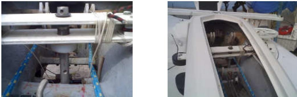
O pedal e a trava são conectados por algum cabo fino (eventualmente 3mm Nylon ou Spectra). A trava deve ter acionamento positivo (travar) por um cabo elástico e acionamento negativo (isto é distravar) pelo pedal.
