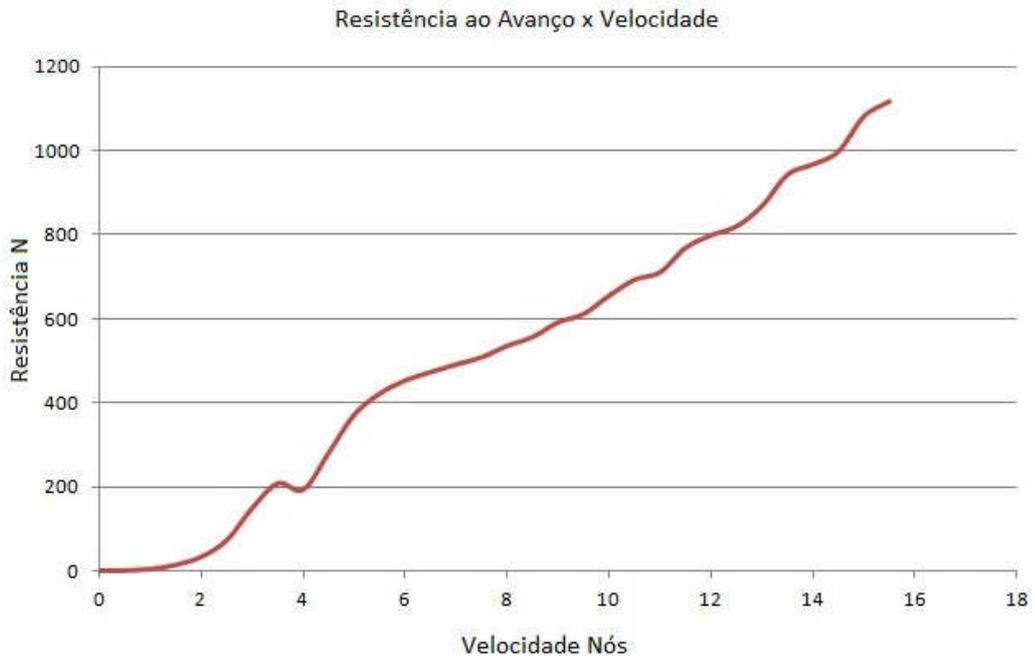
Em determinada velocidade da embarcação, a projeção da componente horizontal da força do Kite na direção do rumo da embarcação será igual a força da resistência da água. Por exemplo: Para que o barco alcance uma velocidade de 10 nós, a componente horizontal da força do Kite projetada na direção do rumo do barco deve ser 62 kg-f. A Figura 42 mostra a representação gráfica calculada pelo método de corpos esbeltos para a velocidade de 10 nós.
