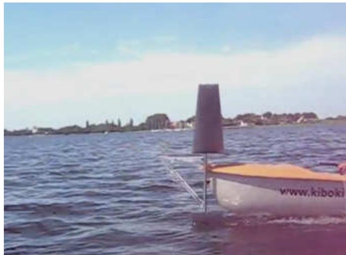
Em filme apresentado na internet, os efeitos da força do Kite na geração de um momento azimutal sobre o casco do barco aparentam realizar considerável melhoria sobre o controle do rumo do barco utilizado com a utilização deste mecanismo.
