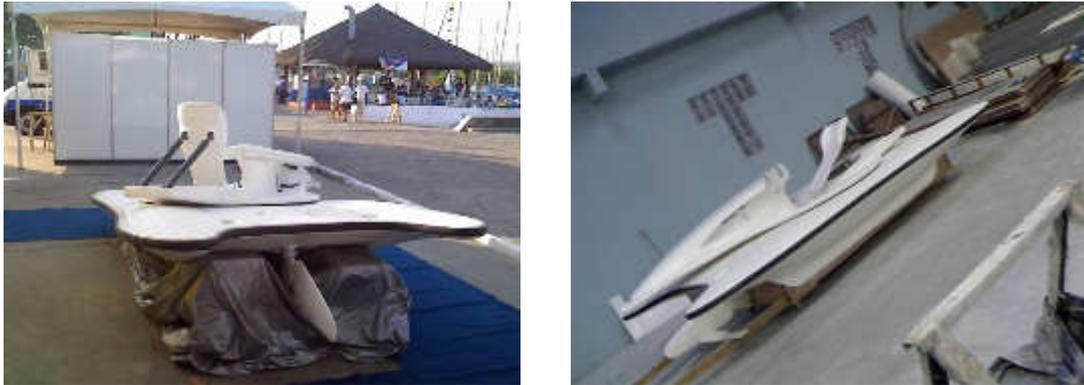
A Figura 96 mostra a plataforma azimutal do Mock-Up de 2008 a qual posteriormente foi adaptada e montada no protótipo de 2011 e equipada com os novos subsistemas mecânicos para os controles do Kite, controle de rumo do barco e o encosto para um piloto.
