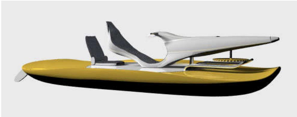
Os desenhos conceituais deram origem ao desenvolvimento de um casco novo. Verifica-se que os conceitos iniciais ainda apresenta um leme, o que posteriormente mostrou-se desnecessário, uma vez que a tecnologia com base na plataforma azimuthal dispensa este equipamento. A Figura 32 mostra as três vistas com planos de linha elaboradas para a fabricação da nova embarcação.
