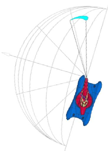
O percurso P7 é favorável para alcançar elevadas velocidades. O Kite permanece no lado extremo da direita da Janela de Vento, operando no regime de sustentação. Neste rumo o deslocamento da Janela de Vento devido a velocidade do barco posiciona o Kite na parte frontal da embarcação e a força exercida pelo Kite é aproveitada de forma mais eficiente. O Kite foi continuamente dirigido em trajetória favorável para gerar mais força.
