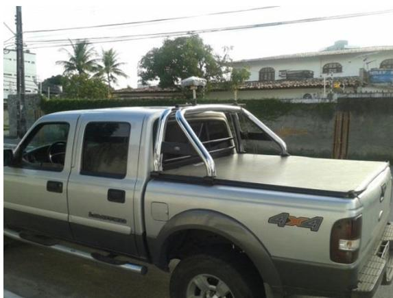
Figura 6 – Antena GNSS Hiper Lite+ (Rover) fixa no automóvel
