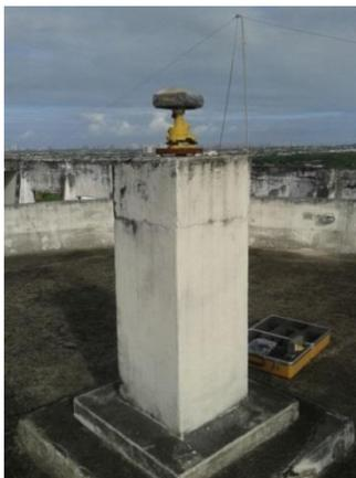
Figura 5 – Antena GNSS Hiper Lite+ (Base) fixa no ponto LAASTRO (Laboratório de Astronomia).
