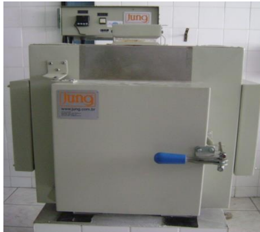
Figura 3.5: Forno tipo Mufla Jung 0614 1400°C – Laboratório de Cerâmicas especiais LCA/ Oficina de engenharia Mecânica - UFPE
