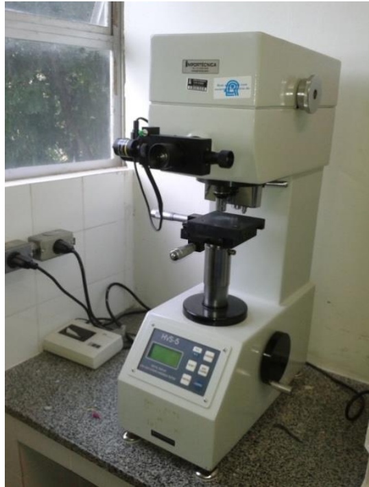
Figura 3.6 – Microdurômetro acoplado a um microscópio metalográfico Zeiss, modelo Jenavelt com penetrador modelo HVS-5 nº 0021, Laboratório de Cerâmicas Especiais LCA/ oficina de Engenharia Mecânica, CTG – UFPE.
