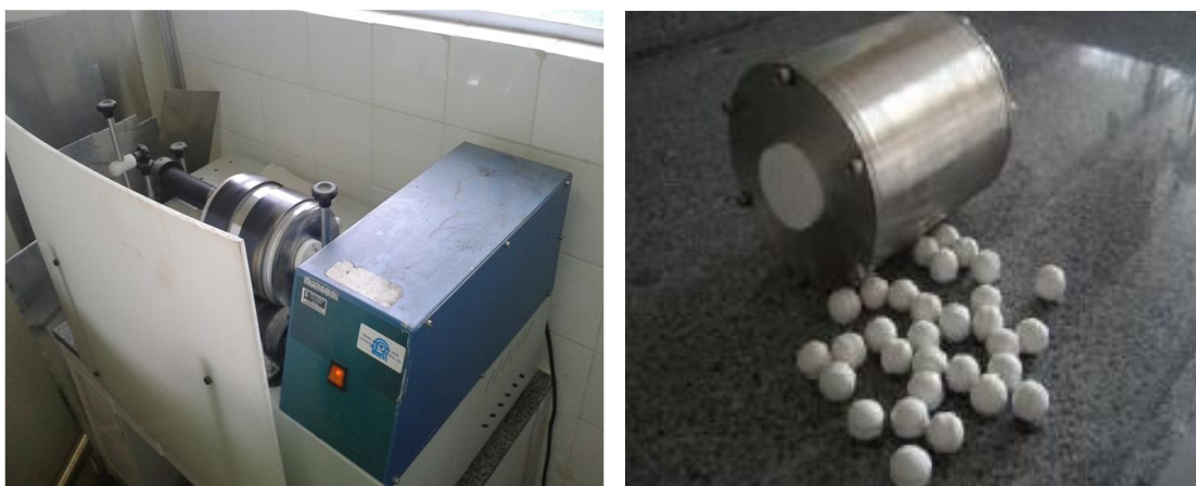
Figura 3.2 Moinho de bolas usado na moagem, Laboratório de Cerâmicas Especiais, Departamento de Engenharia Mecânica, UFPE.
