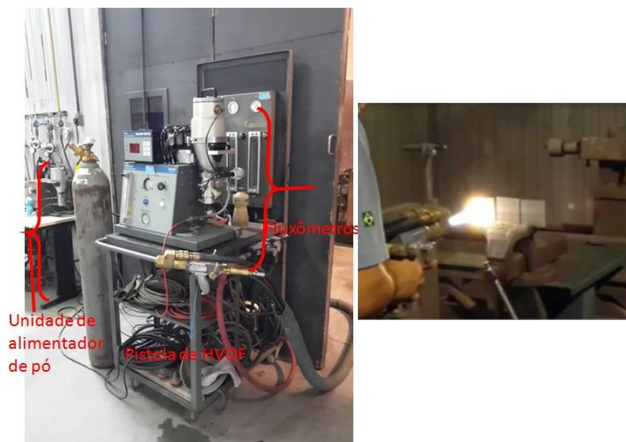
Figura 3.11 – Equipamento de Aspersão HVOF e processo de aspersão nos corpos-de-prova. Aspersão feita na Revesteel – PR.
