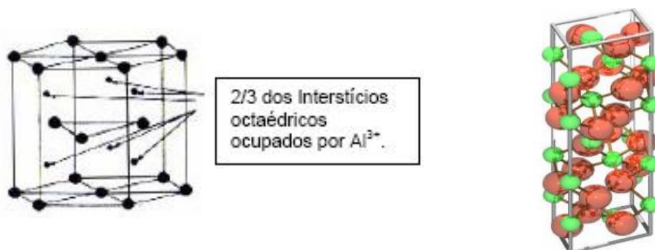
Figura 2.1 – Representação da estrutura cristalina romboédrica da \alpha – alumina. Em verde estão representados os átomos de alumínio e em vermelho átomos de oxigênio.
