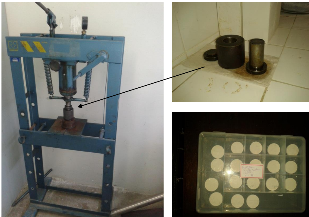
Figura 3.4 – Prensa Hidráulica (SCHWING SIWA, ART6500089 modelo), matriz metálica e pastilhas.
