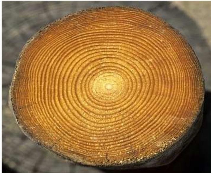
Figura 1.4: Secção de tronco mostrando anéis de crescimento. Mais próximos à casca, os anéis se tornam cada vez mais finos. (Fonte: <http://m.inmagine.com/image-ptg01406975-Tree-trunk-cross-section:-tree-rings.html>)
