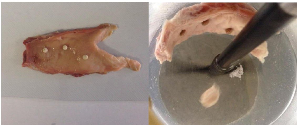
Figura 36- Fotos dos comprimidos da mistura goma do cajueiro/pilocarpina antes e após início do teste de tempo de mucoadesão.
