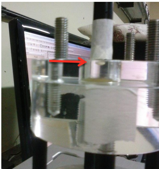
Figura 6. Ilustração do comprimido fixado no probó e na parte inferior disco de mucina para iniciar o teste de força de mucoadesão.
