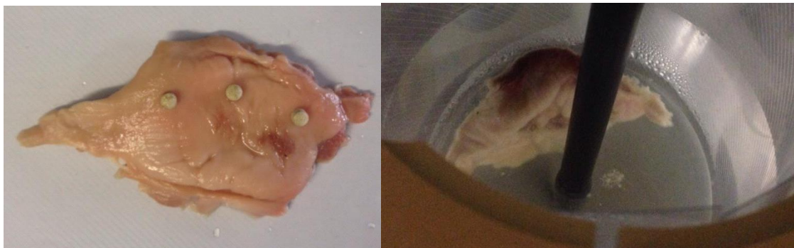
Figura 39- Fotos dos comprimidos da blenda/pilocarpina fixados na mucosa antes e no final do teste de tempo de mucoadesão.
