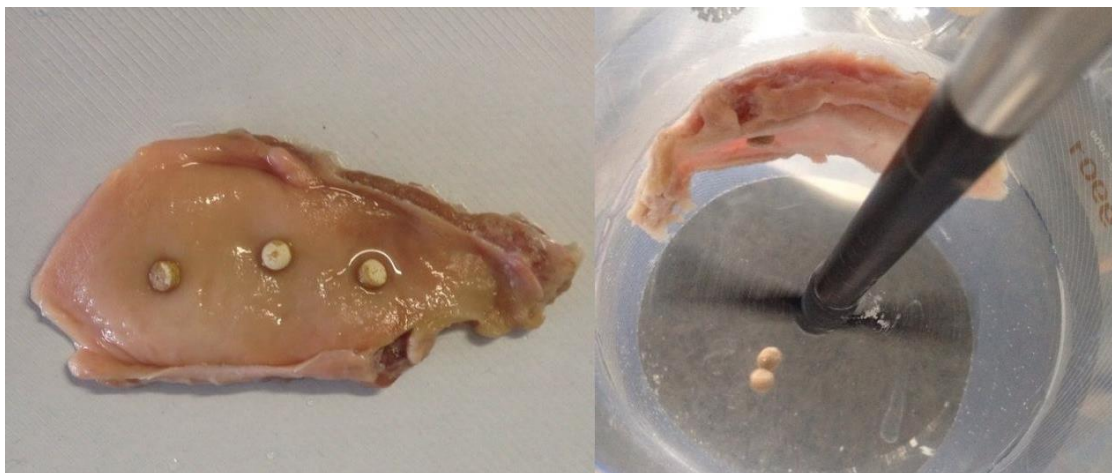
Figura 38- Fotos dos comprimidos da mistura física/pilocarpina antes e no início do teste de tempo de mucoadesão.
