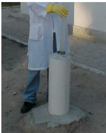
**Figura 6** - Amostra de água sendo coletada com coletor do tipo beiler no Poço de Observação 2
