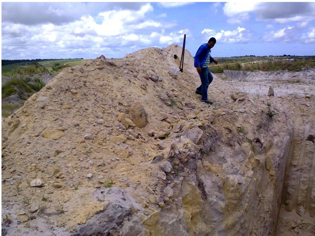
*Figura 26 – Escavações mostrando o perfil do solo.
