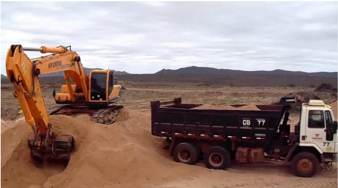
*Figura 3 – Lavra pelo método de Desmonte Mecânico.
