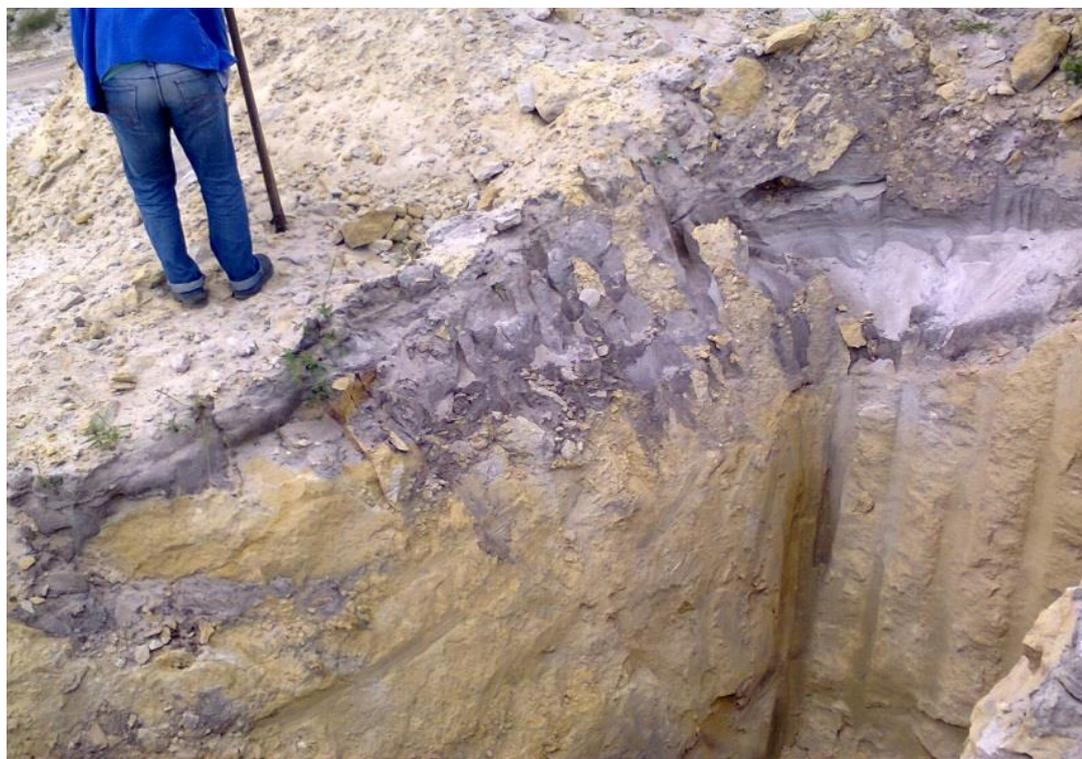
*Figura 25 – Escavações mostrando o perfil do solo.
