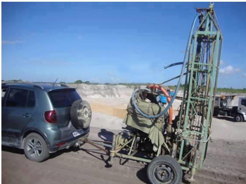
*Figura 24 – Equipamento para realização da sondagem.
