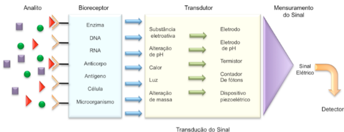
Figura 2. Desenho esquemático de um biossensor
