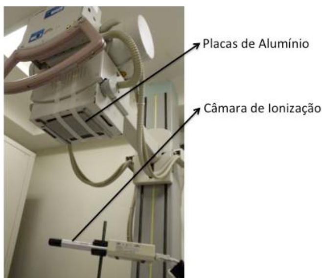
Figura 16 Arranjo experimental para a determinação da camada semirredutora
