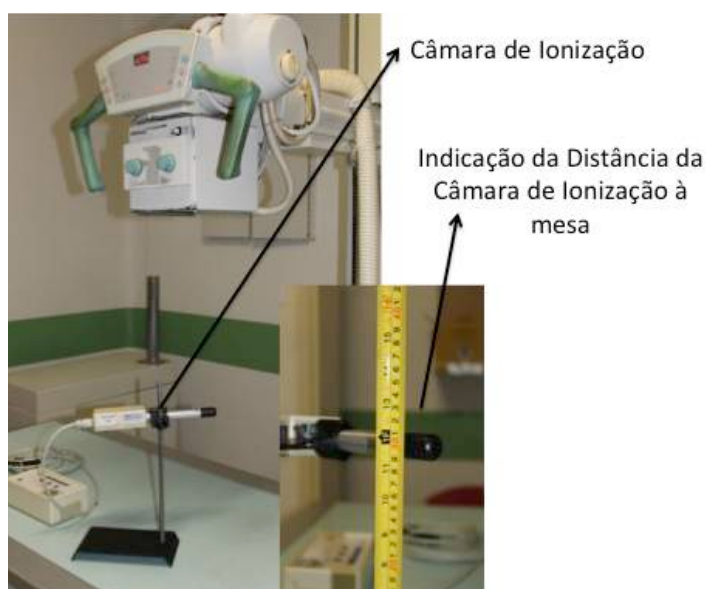
Figura 15 Arranjo experimental para o teste da linearidade e reprodutibilidade da taxa de kerma no ar, mostrando o posicionamento correto da câmara de ionização, para leitura de doses e taxas de dose
