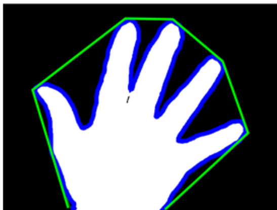
Figura 15: Determinação do convexhull na imagem binarizada
