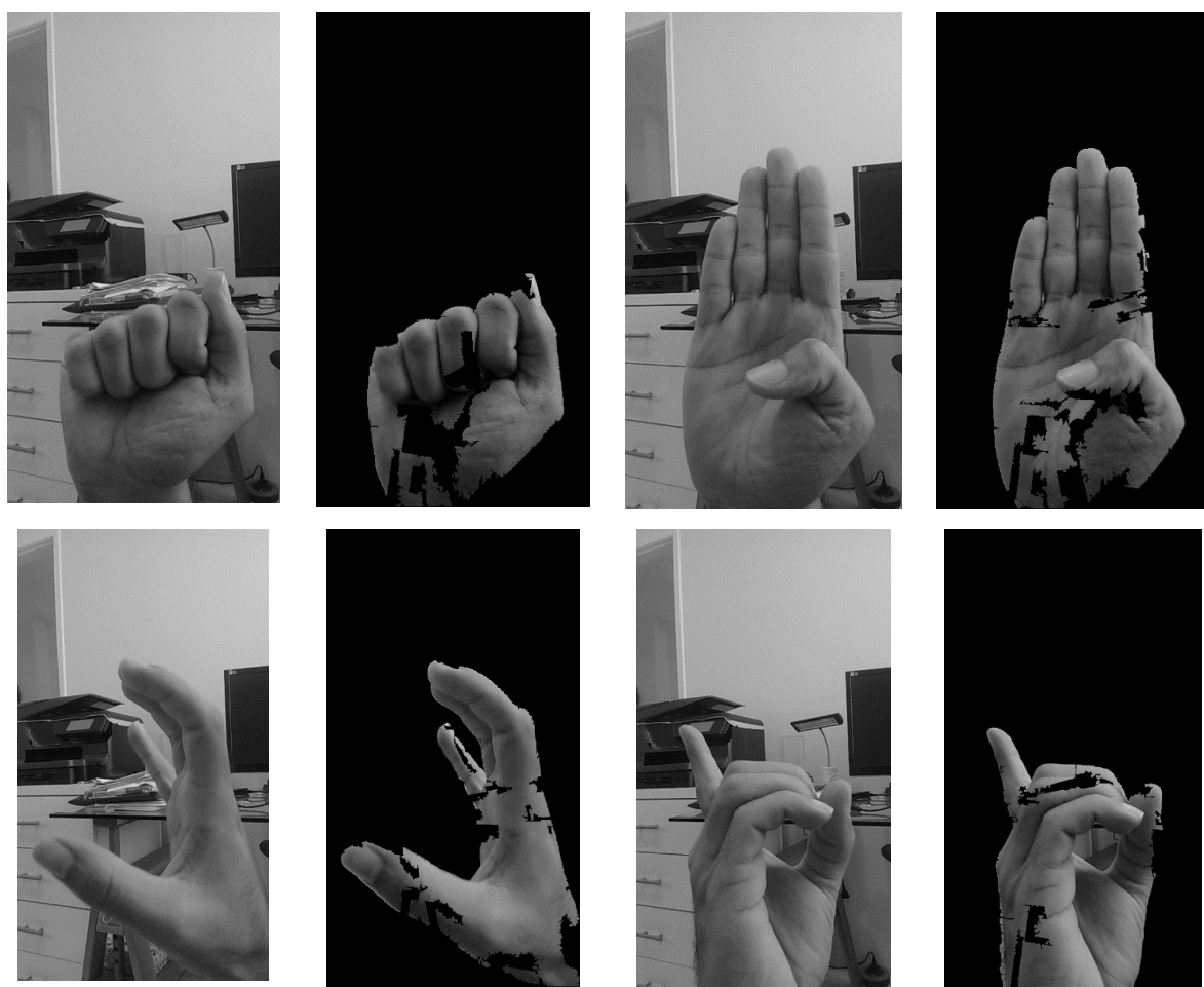
Figura 46: Remoção do plano de fundo complexo Usando BackgroundSubtractorMOG2
