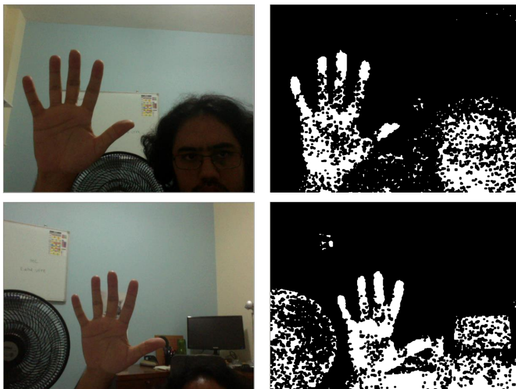
Figura 30: Resultados obtidos para detectar pele para fins deste trabalho
