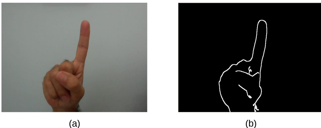
Figura 33: Resultado do filtro de Canny
