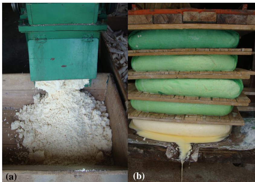
Figura 2 – Trituração (a) e prensagem da mandioca (b). Fonte: Autor, 2013.
