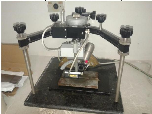
Foi utilizado um feixe monocromático com comprimento de onda  $\lambda = 2,2911 \text{ \AA}$  do tipo Cr K- $\alpha$ , a tensão de operação for de 25kV e a corrente de 50 mA. O método foi o do  $\text{sen}^2\theta$ .
