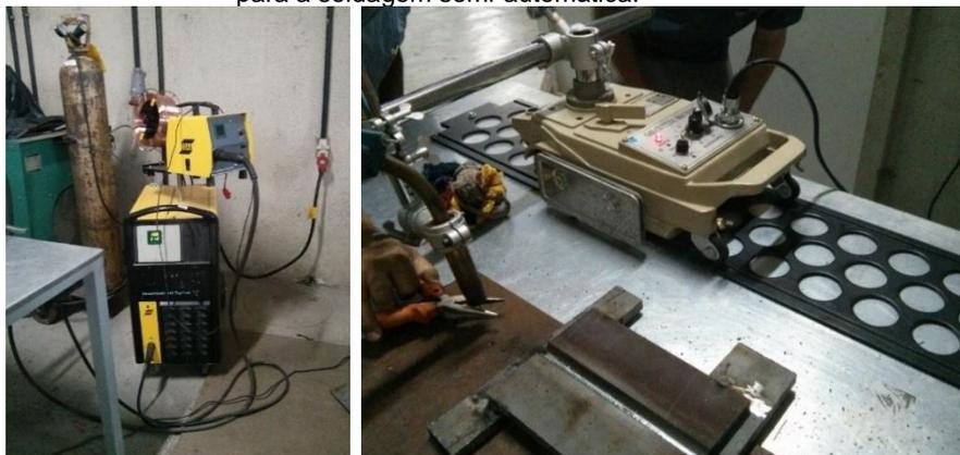
Para o processo de soldagem MIG/MAG foi utilizado um arame de bitola de 1,2 mm e tipo ASME SFA 5,18 ER70S-6, com um gás de 25% de Ar e 75% de CO<sub>2</sub>.
