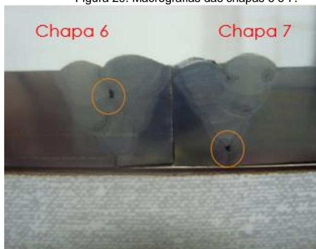
Nessa figura ficam nítidos alguns defeitos de soldagem, como por exemplo, a falta de penetração, a falta de fusão e inclusão de escória. Tais defeitos são prejudiciais à operação da junta, porém não invalidam a utilização dessas juntas porque todas as tensões residuais medidas nesse trabalho são macrotensões e os parâmetros de soldagem foram escolhidos com objetivo influenciar as tensões residuais medidas.
