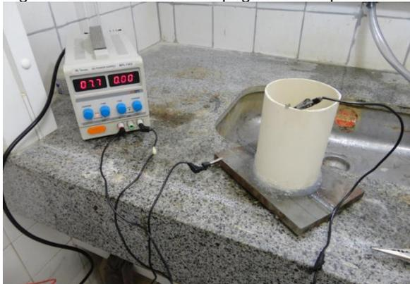
Ao final da decapagem, foram realizadas três marcações na ZTA e duas no cordão de solda, a fim de se obter as tensões residuais pelo método de DR-X.
