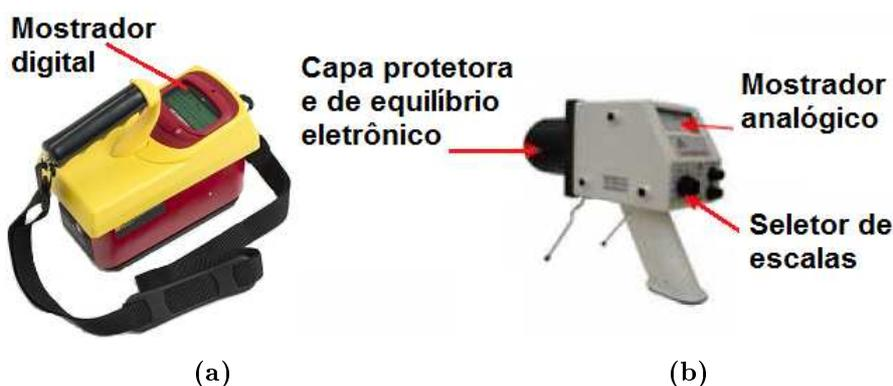
Figura 1.5: Dosímetros com câmara de ionização.
