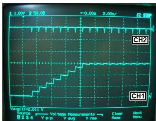
Figura 4.17: Oscilograma da integração de pulsos dos amplificadores.
