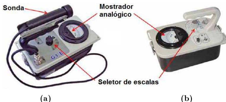
Figura 1.4: Dosímetros com detector Gieger-Müller.
