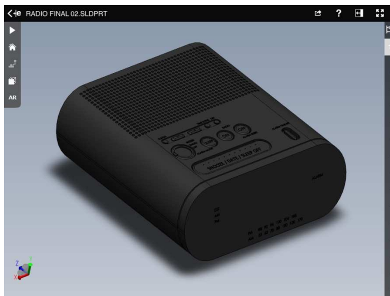
Figura 7.4 – Protótipo virtual do rádio relógio visualizado na tela do iPad a partir do software eDrawings
