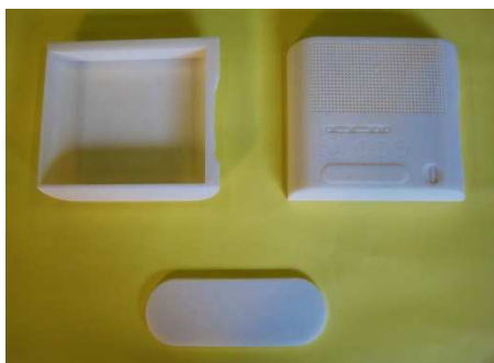
Figura 4.10 – Divisão do modelo em diversas partes para impressão 3D e montagem do modelo final
