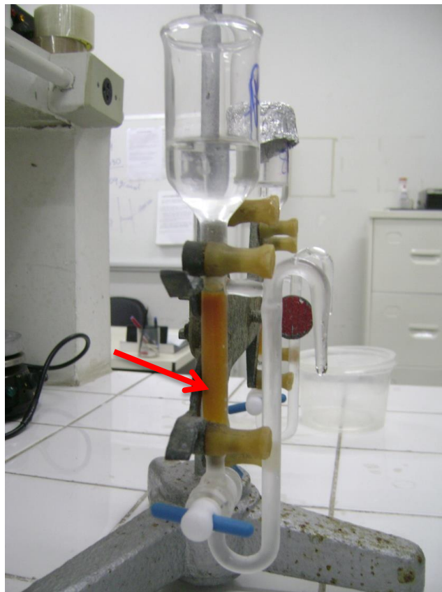
Figura 21. Coluna de percolação contendo a resina trocadora de íons indicado pela seta vermelha
