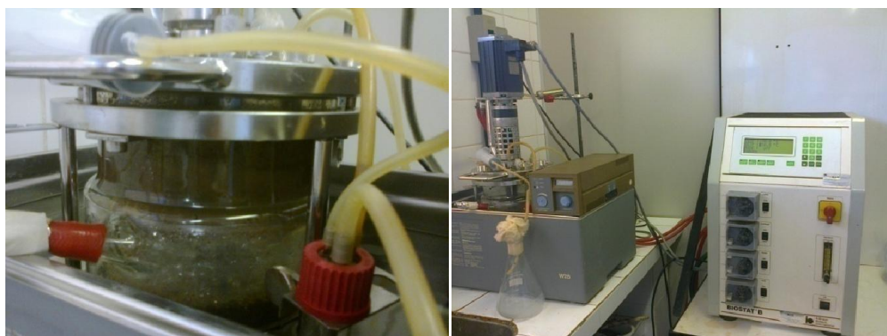
Figura 3.3. Processo de produção de acetoína em biorreator
