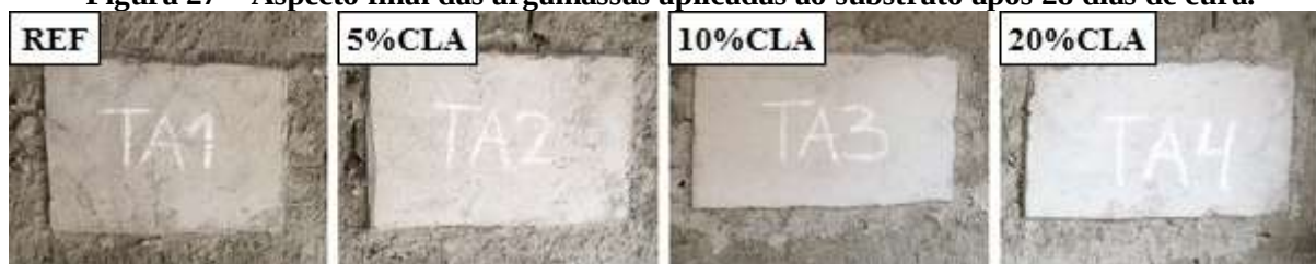
Figura 27 – Aspecto final das argamassas aplicadas ao substrato após 28 dias de cura.
