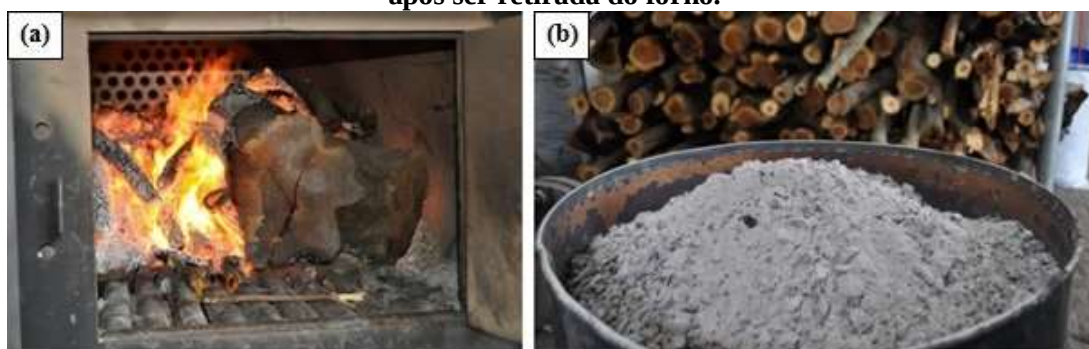
Figura 8 – (a) Queima de lenha de algaroba em forno industrial; (b) Cinza da lenha de algaroba após ser retirada do forno.
