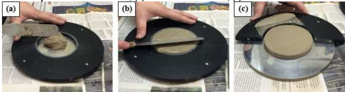
Figura 11 – Etapas para preparação da amostra para o ensaio de squeeze flow : (a) preenchimento do molde; (b) rasamento da amostra; (c) retirada do molde.
