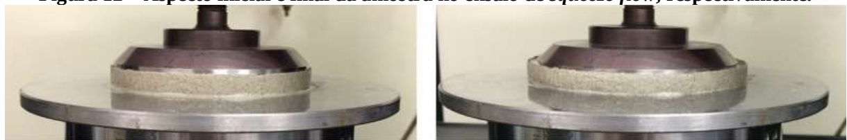
Figura 12 – Aspecto inicial e final da amostra no ensaio de squeeze flow , respectivamente.
