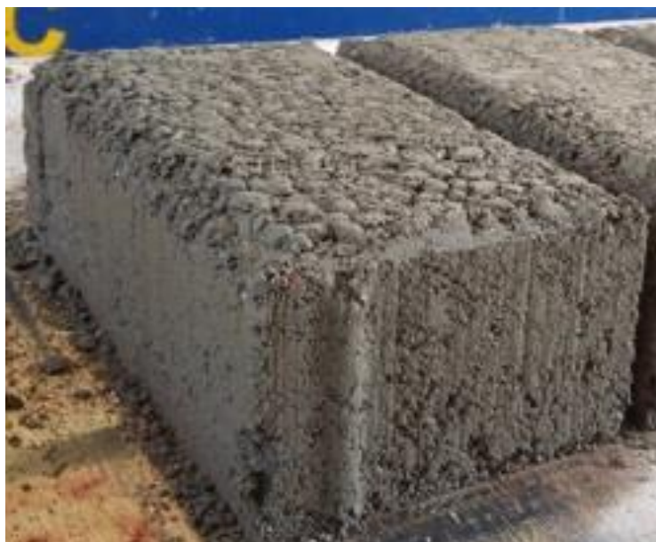
Figura 25 - Bloco com maior quantidade de pedrisco
