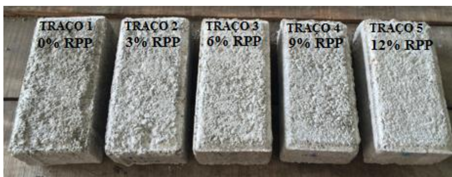
Figura 29 - Blocos intertravados de concreto com RPP
