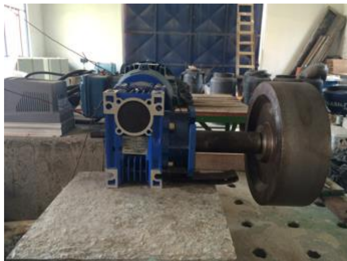
Figura 19 - Dispositivo para ensaio de resistência a abrasão
