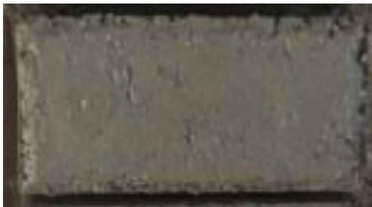
Figura 28 - Bloco muito úmido, traço 3 ( a/c = 0,50 )
