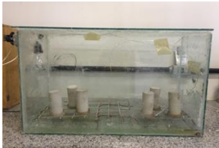
Figura 16 - Câmara úmida fechada, que mantém os blocos a 38°C
