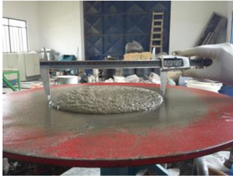
Figura 15 - Ensaio de consistência da argamassa
