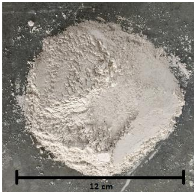
Figura 13 - Resíduo passante na peneira da malha 200 mesh
