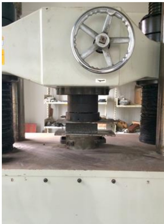
Figura 18 - Dispositivo para ensaio de resistência a compressão
