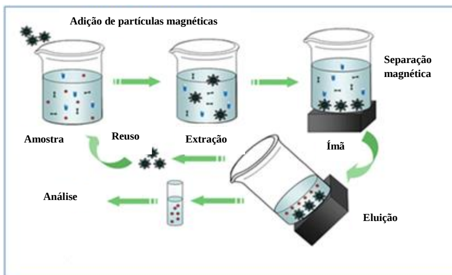
Figura 4. Extração de fase sólida- separação magnética. Reproduzido e adaptado de Wang et al., 2013
