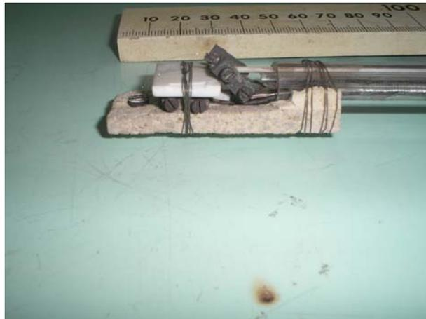
**Figura 25 – Conectores e porta amostra. A base é constituída de alumina e os fios que seguram a mesma no tubo de quartzo são de aço inox.**
