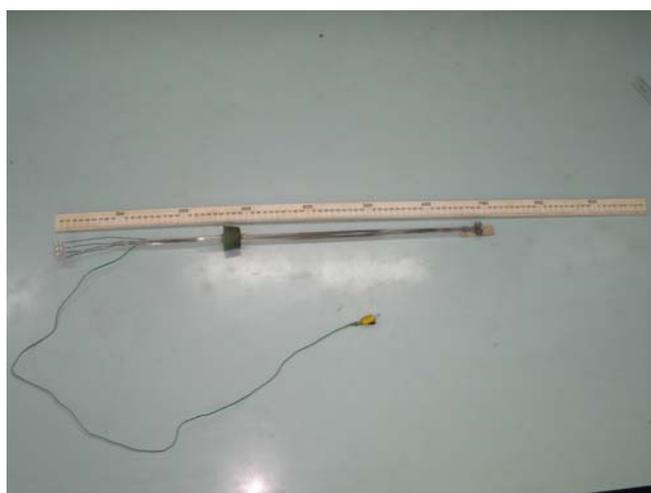
Figura 23 – Aparato desenvolvido para medidas de resistividade elétrica em função da pressão de oxigênio.
