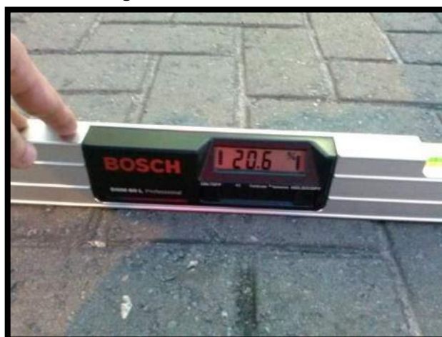
Figura 15 - Declividade longitudinal inadmissível. Fonte: Marcelo Pedrosa. 2014.
