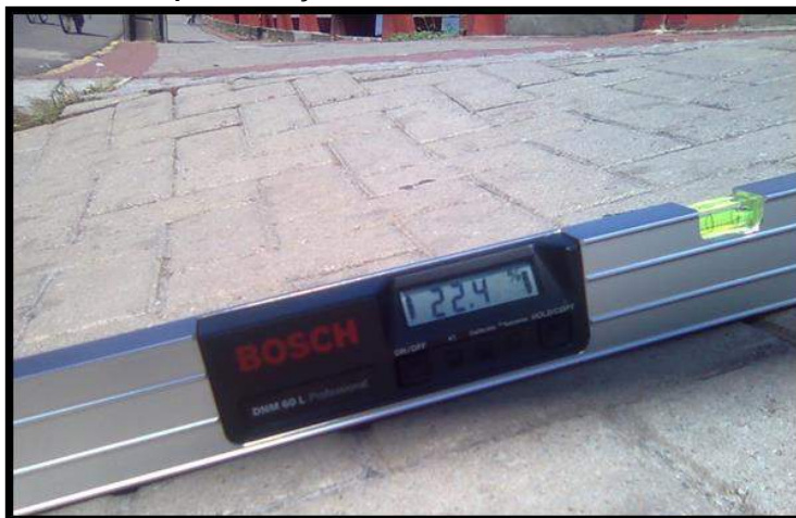
Figura 9 - Clinômetro para medição de declividade. Fonte: Marcelo Pedrosa. 2013.
